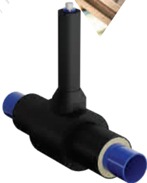
**Полный проход | Цельносварной под приварку с удлиненным шпинделем, в ППУ изоляции и полиэтиленовой оболочке под T-образный ключ 11с67п 6ЦП.00(01).10**
